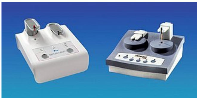
Abb. 7: Der Guttafusion (links) und GuttaMaster-Ofen (rechts) kann maximal zwei Obturatoren erhitzen. Hierfür werden die Trägerstifte in den dafür vorgesehenen Halterungen befestigt und dann nach unten gedrückt. Das Erreichen der erforderlichen Temperatur wird durch Licht- bzw. akustischem Signal angezeigt.
