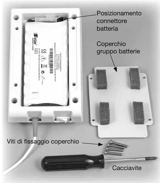
Figura 3 – Gruppo batterie inserito
