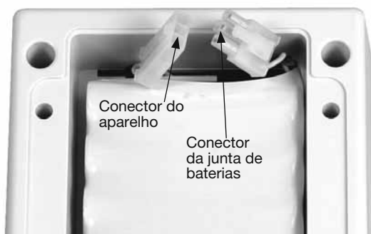
Imagem n° 2 – Alinhamento do conector da junta de baterias
