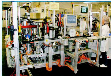
Spezialmaschinen übernehmen das Bedrucken der Stahlfeilen und Nervnadeln.
